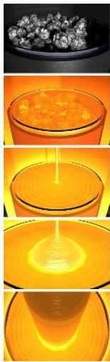
圖 1.1 長晶製程示意圖
