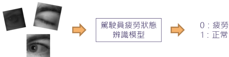
圖 3 駕駛員疲勞狀態辨識模型流程示意圖
